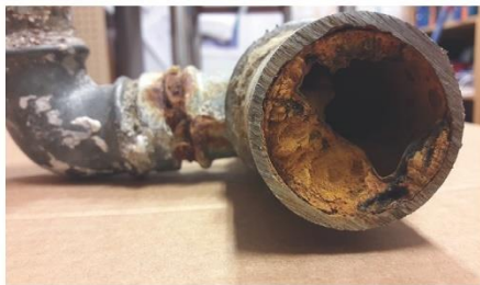
Yli 50 vuotta vanhat vesijohdot voivat kasvaa lähes umpeen ja heikentää veden laatua.
